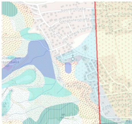
Der Untergrund des Baugeländes besteht aus fluviatilen Kiesen und Sanden, die nach der letzten Eiszeit vom Inn sedimentiert wurden. Darüber folgen Schwemmfächerablagerungen die aus dem westlich gelegenen Mangfallgebirge über den Auerbach und den Röthenbach ins Tal transportiert wurden.
